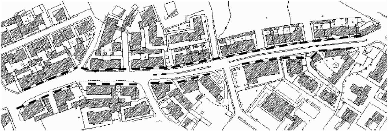
Figura E1: Gli edifici in fila posti in affaccio sull'infrastruttura stradale, offrono protezione dal rumore del traffico a quelli retrostanti.
